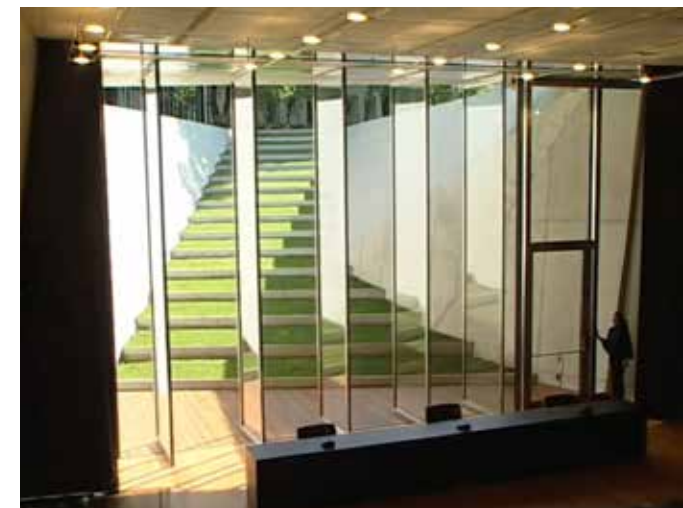
Sonderantriebseinheit für freischwebende Torflügel. Die Torflügel drehen sich simultan und verschieben sich seitlich automatisiert The door leaves turn simultaneously 90° and slide sideways automatically
