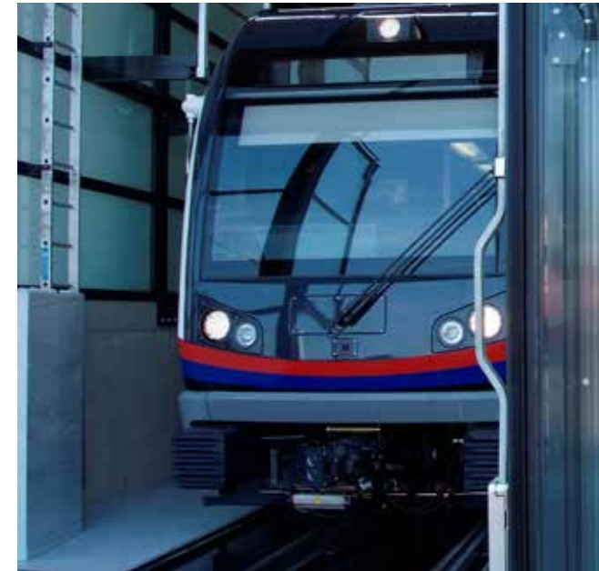
Falttöre für die Bahn mit Fahrdrahtausschnitt Folding doors for trains including overhead wire cutout
